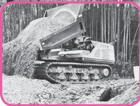
地下排水工に使用するフィルター材や現場内で資材を運ぶ不整地運搬車です。名前の通り、整地をされていない現場内の工事用道路を走り回ります (^o^)
